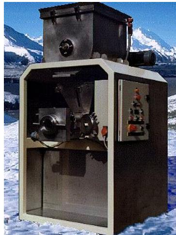
La TMI SIMPLEX est composée d'un mélangeur de capacité 25 kg et d'une boudineuse avec option d'affinage d'une capacité d'extrusion de 50 à 80 kg/heure.
