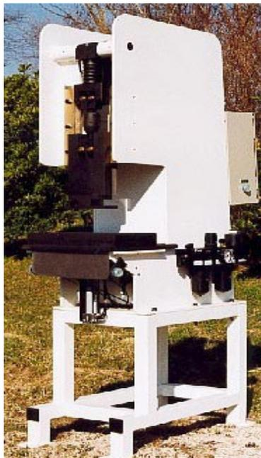
De type pneumatique, cette Presse Semi-automatique est à commande bi-manuelle.
