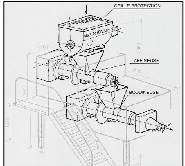
La TMI INDUS est une machine révolutionnaire tout en inox qui regroupe un **mélangeur**, une **affineuse** et une **boudineuse** disposés en cascade permettant de produire une barre de savon compacte, lisse et homogène en un seul passage.
