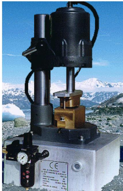
La Presse Semi-automatique d'Établi est une innovation dans le domaine de la production de mise en forme des savons de 25g à 150g sur presse manuelle semi-auto ( cadence de 20 savons à la minute ) à encombrement réduit.
